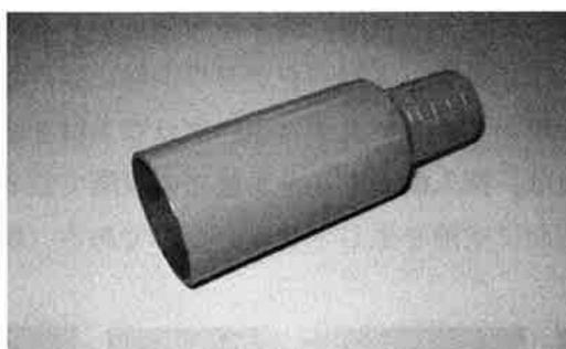
解説写真-3.6 ホース先端治具の例
